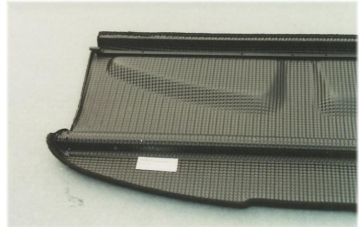
**Umgeformt einschließlich Teppich in einem einfachen Umformwerkzeug aus einer kaschierten und konturgestanzten Platine in einigen Bereichen nachbeschnitten**
